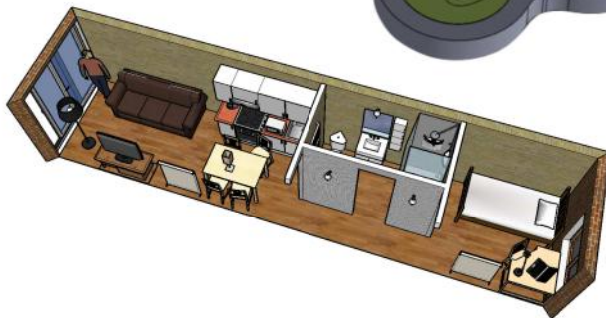
Aménagement d'un conteneur en logement étudiant
