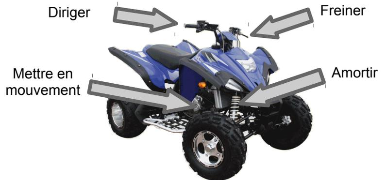
Pour remplir sa fonction d'usage, le quad a besoin des fonctions techniques : Mettre en mouvement, diriger, freiner, amortir, etc.
