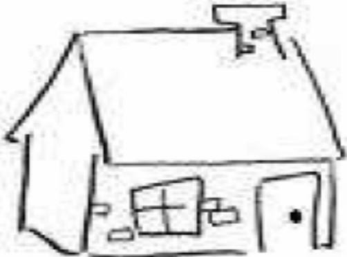
Le croquis : il représente un objet, par un dessin rapide, généralement à main levée. On peut y insérer les mesures à l'aide de flèches.
